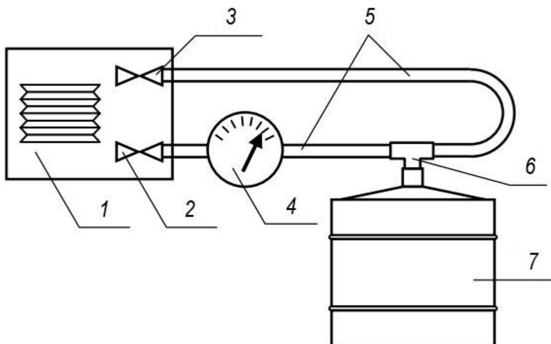
1 – аппарат ИВЛ; 2 – клапан выдоха аппарата ИВЛ; 3 – клапан вдоха аппарата ИВЛ;
