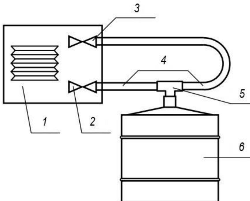
1 – аппарат ИВЛ; 2 – клапан выдоха аппарата ИВЛ; 3 – клапан вдоха аппарата ИВЛ;
