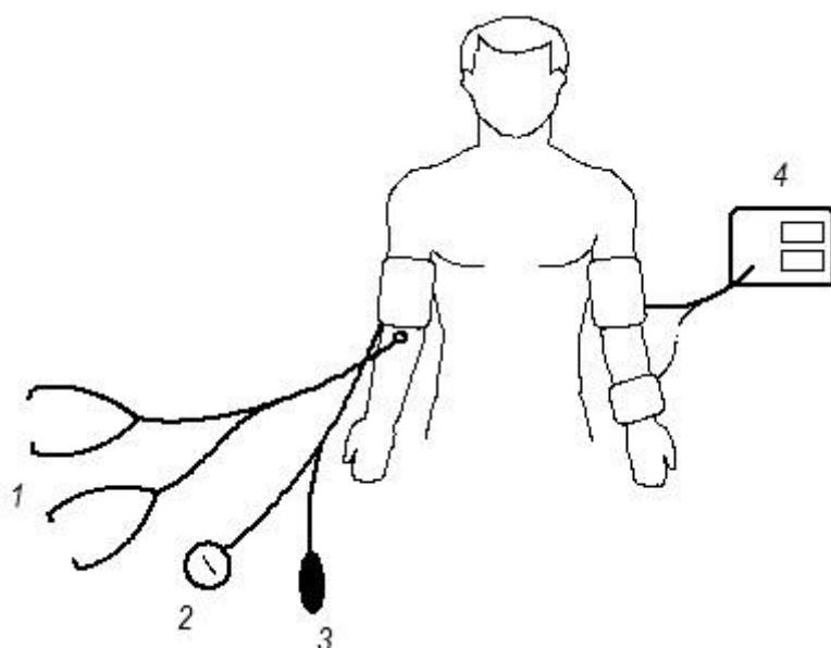
1 – двойной стетоскоп; 2 – дисплей ЭТАЛОННОГО СФИГМОМАНОМЕТРА; 3 – ручной нагнетатель воздуха ЭТАЛОННОГО СФИГМОМАНОМЕТРА, 4 – ИСПЫТУЕМЫЙ СФИГМОМАНОМЕТР
