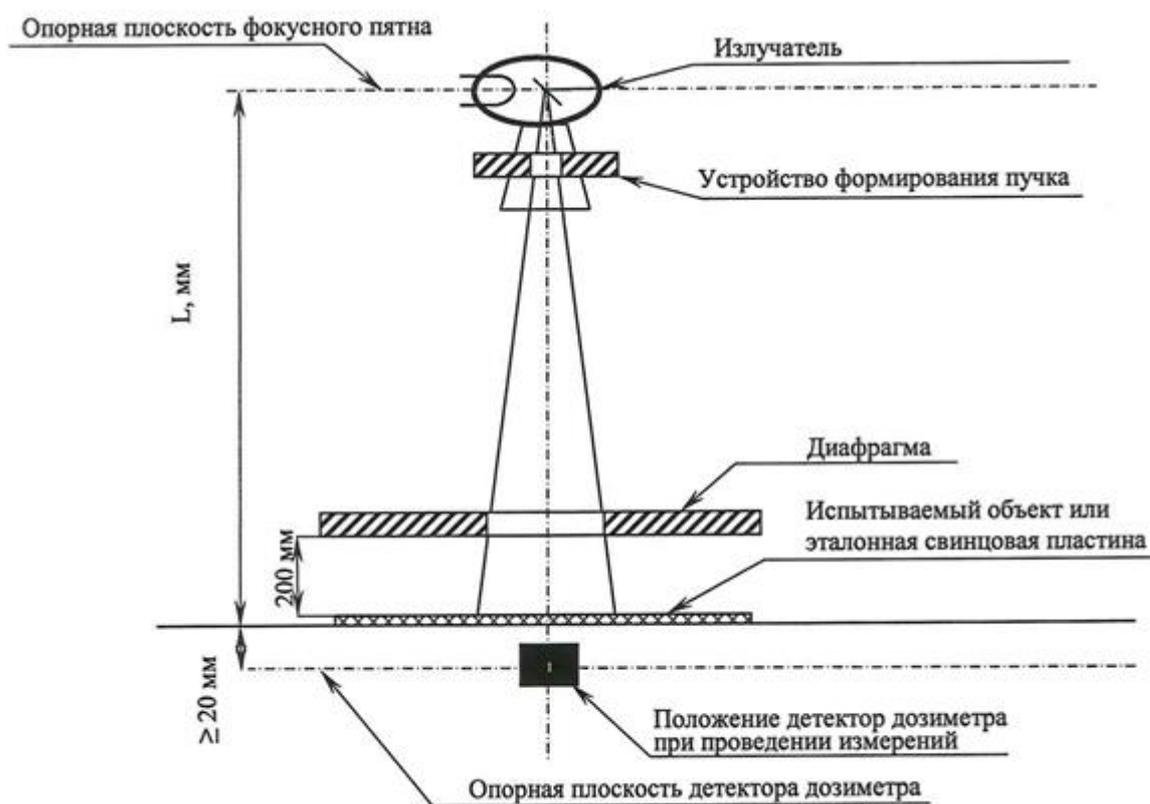
Рисунок 2 – Геометрическая схема проведения испытаний
