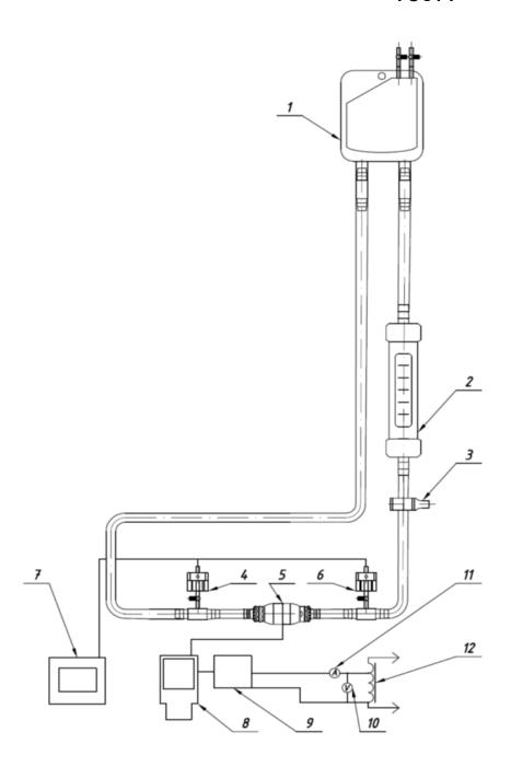
1 – мешок для инфузий объемом не менее 500 мл; 2– поплавковый ротаметр; 3 –
