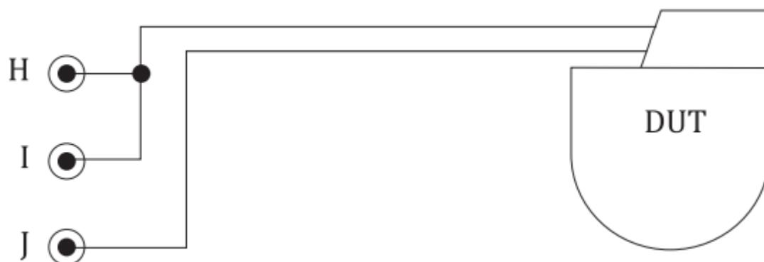
Рисунок 17 — Подключение к одноканальному биполярному изделию в дифференциальном режиме
