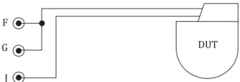
Рисунок 6 — Подключение к одноканальному биполярному изделию в дифференциальном режиме
