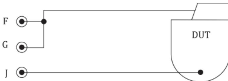
Рисунок 3 — Подключение к одноканальному однополярному изделию
