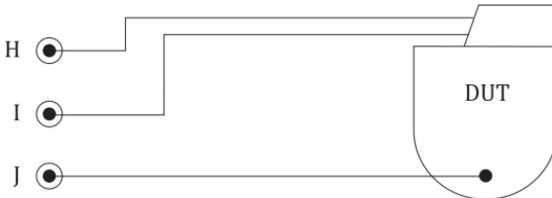
Рисунок 16 — Подключение к одноканальному биполярному изделию в обычном режиме
