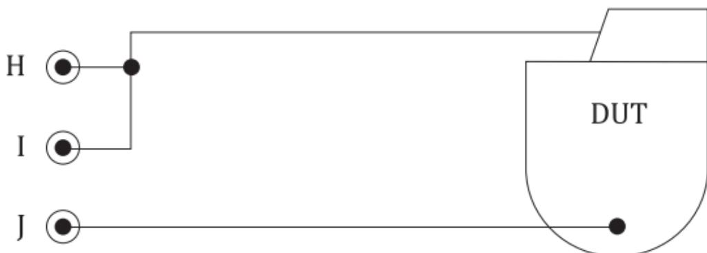
Рисунок 14 — Подключение к одноканальному однополярному изделию
