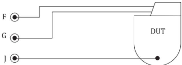
Рисунок 5 — Подключение к одноканальному биполярному изделию в общем режиме
