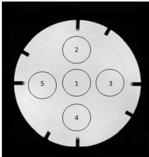
Рисунок 4 – МР-изображение для оценки величины неравномерности распределения яркости поля изображения
